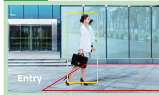
Une alarme se déclenche lorsqu'un sujet pénètre dans une zone définie. Il est également possible de distinguer si le sujet qui entre dans la zone programmée est une personne ou un véhicule, en créant des consignes d'activation d'alarme personnalisées.
