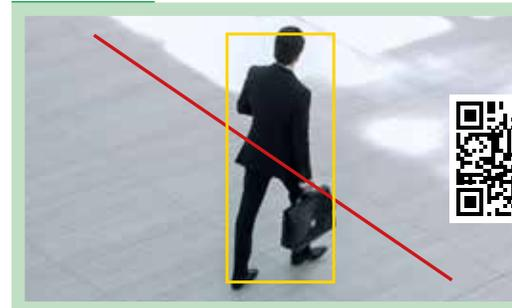
Une alarme se déclenche lorsqu'un sujet traverse une ou plusieurs lignes configurées. Il est possible de distinguer si le sujet qui traverse la ligne en question est une personne ou un véhicule, en créant des consignes d'activation d'alarme personnalisées.
